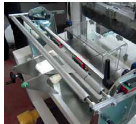
Conformador ajustable en medidas que abarca una gran variedad de productos a poder embolsar.
